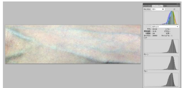
図 8 図 5 の RGB 値の分布が 0% から 100% になるよう変換した画像。静脈の画素は青い色相になる。
